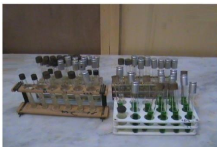
الشكل (4) أنابيب اختبار تحتوي على حساء ماکونكي وعينات من مياه البحيرة
